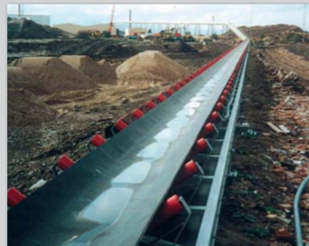
Komplet 400 t/h transportanlæg fra tippunkt til lagerfordeling udført for cementfabrik i Togo, Afrika.
