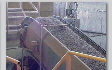
Stållamelbånd transporterer varme letklinker fra rotéovn og køler.
