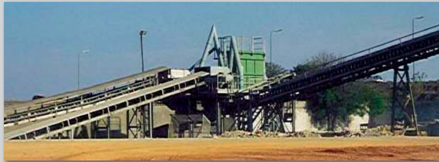
Komplet 400 t/h transportanlæg fra tippunkt til lagerfordeling udført for cementfabrik i Togo, Afrika.
