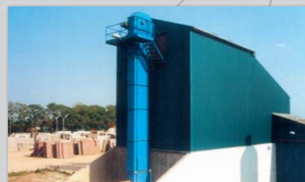
Eksempler på siloanlæg med kopelevator.
